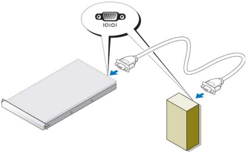
**REMARQUE :** Vérifiez que les paramètres du logiciel d'émulation de terminal utilisé sur le système client sont définis comme suit : 115200 bauds, 8 bits de données, aucune parité et 1 bit d'arrêt.
